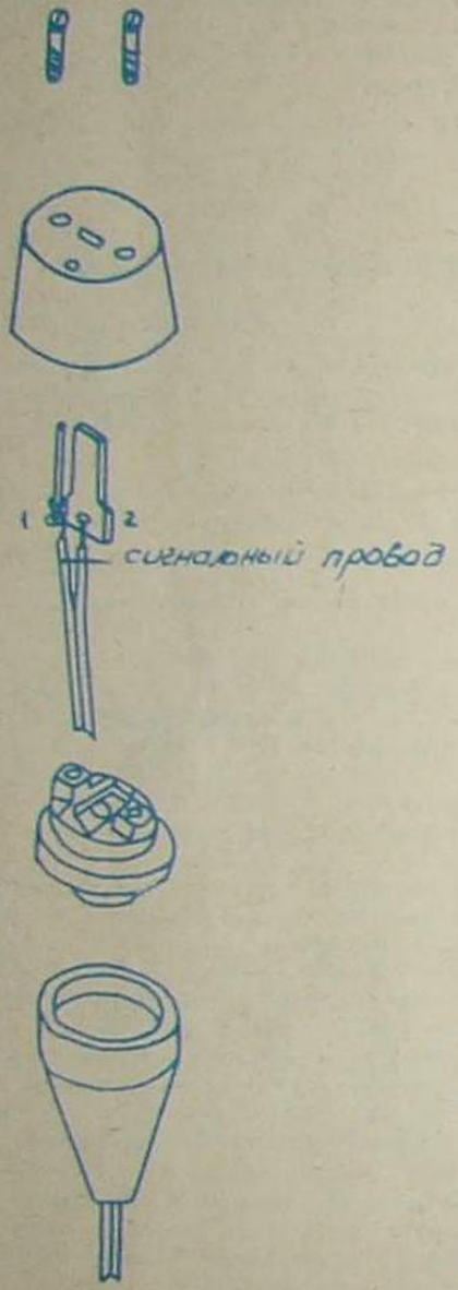
Рис. 4. Схема распайки разъема BVH4-2-Ш7.
